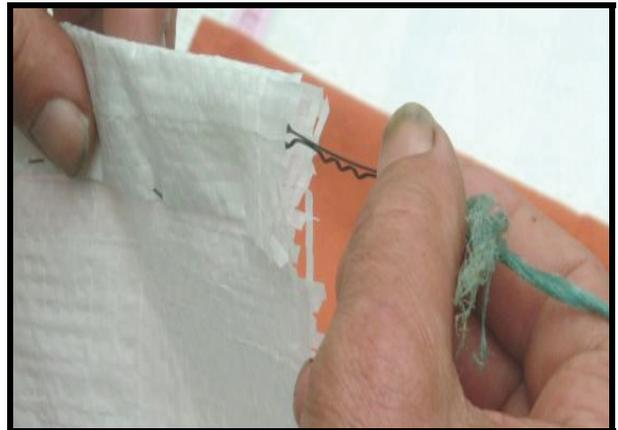
**5. Poussez la ficelle en utilisant l'objet effilé jusqu'à ce qu'elle ressorte de l'autre côté.**
