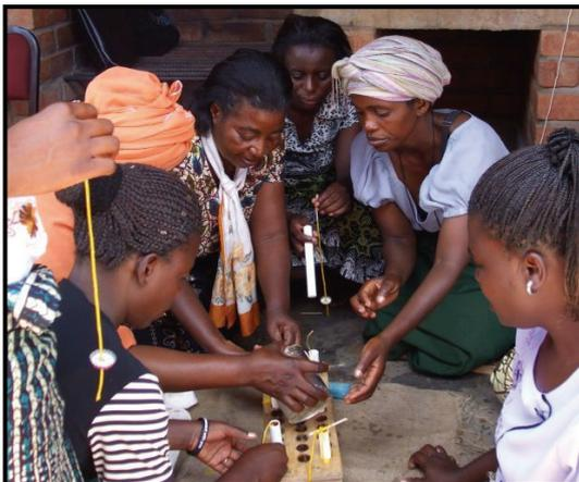
Ce groupe de femmes Malawi est en train de confectionner des bougies avec des morceaux de tuyaux en matière plastique utilisés pour l'eau. Le fond est obturé avec un bouchon de bouteille.
